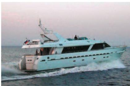
Буревестник — моторная яхта VIP-класса длиной 27,4 метра, шириной 6,5 метров и водоизмещением 87,80 тонны. Рассчитана на 6 пассажиров и 30 гостей, два двигателя развивают скорость до 22 узлов. Салон отделан красным деревом особого сорта "махагон
